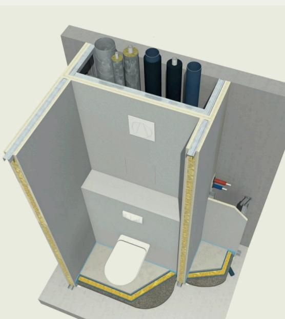
Um Betriebs- und Installationsgeräusche zu minimieren, sollten die Gewerke sauber getrennt sein, um zu vermeiden, dass sich unterschiedliche Frequenzen überlagern.
